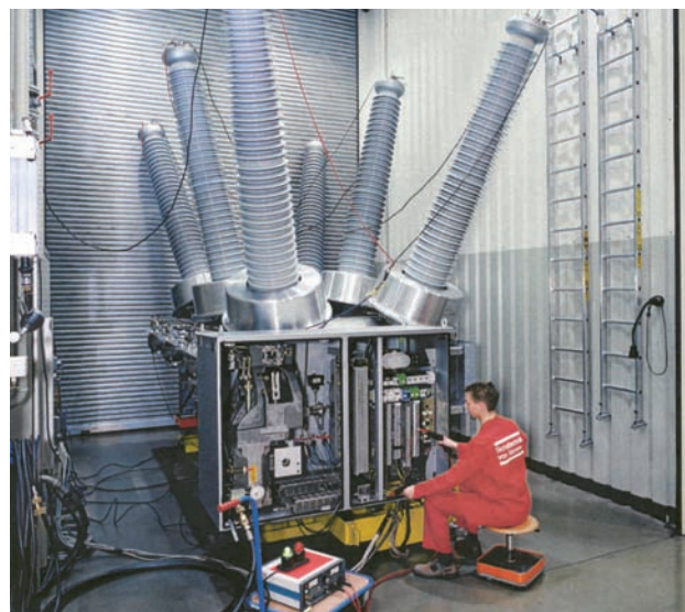
Заводские испытания выключателя 3AP1 DT 245 кВ
