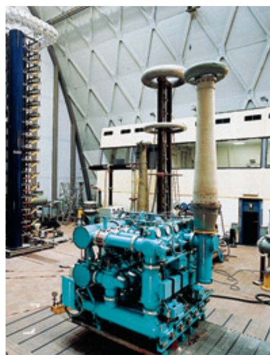
Высоковольтные испытания всего транспортного модуля
