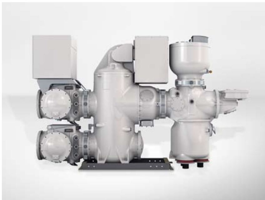
Компактность благодаря трехполюсной изоляции: установка типа 8DN8 на напряжение 145 кВ, ячейка КРУЭ с двойной сборной шиной и модулем кабельного ввода
