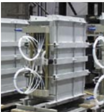
Реактор для линии постоянного тока с водяным охлаждением
