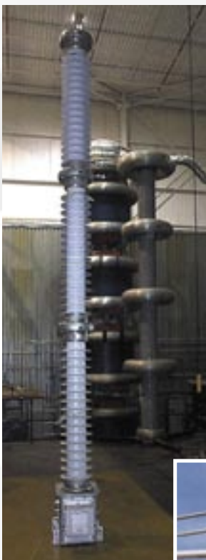
Емкостной трансформатор напряжения на напряжение 345 кВ с элегазовой изоляцией и крышкой из композитного материала
