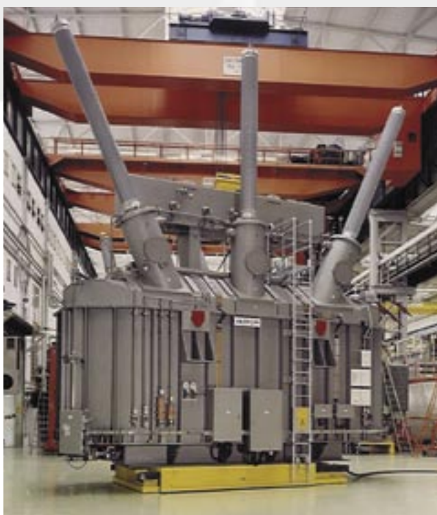
Трансформаторные вводы на напряжение 420 кВ и 123 кВ с масляной изоляцией и крышкой из композитного материала
