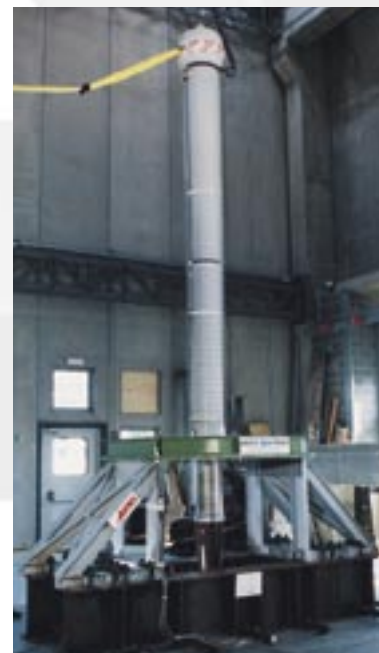
Сейсмические испытания ввода на напряжение 500 кВ
