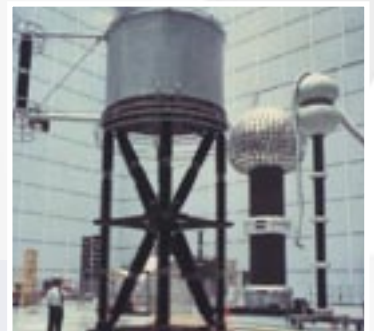
Сглаживающий реактор на напряжение 500 кВ
