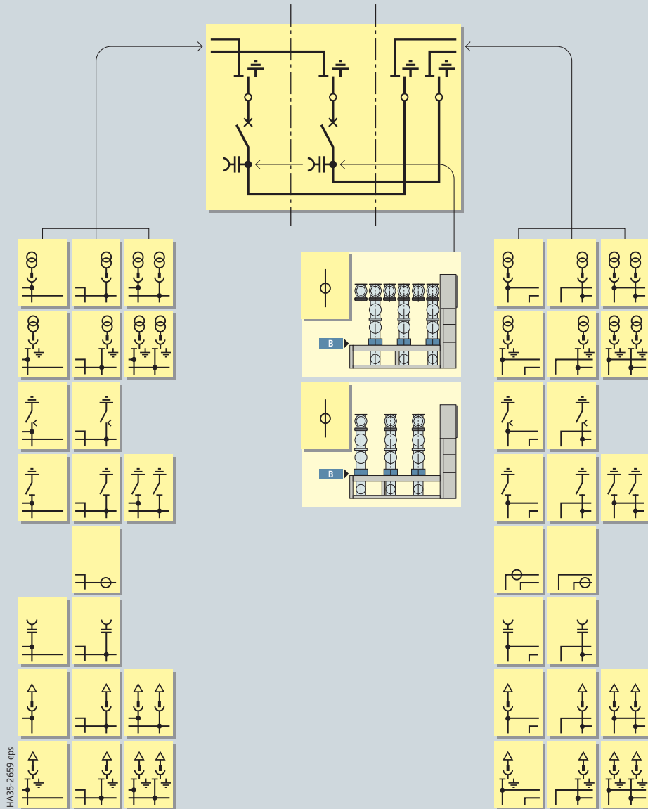
Секционный выключатель (3 ячейки) BS 3
